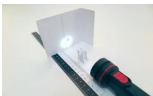
凸レンズと懐中電灯で、スクリーンに物体の像を映します。中学の学習内容を実験や作図に挑戦することで、理解を深めていきます。
