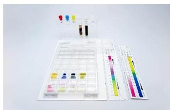
BTB液などの指示薬を使った実験の他、塩酸と水酸化ナトリウム溶液の中和反応も行います。
