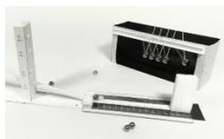
斜面を転がる球の運動を観察し、力学的エネルギーについて楽しく学びます。また、ニュートンのゆりかごを作成し、連続した衝突によって力学的エネルギーが順番に伝わる様子も観察します。
